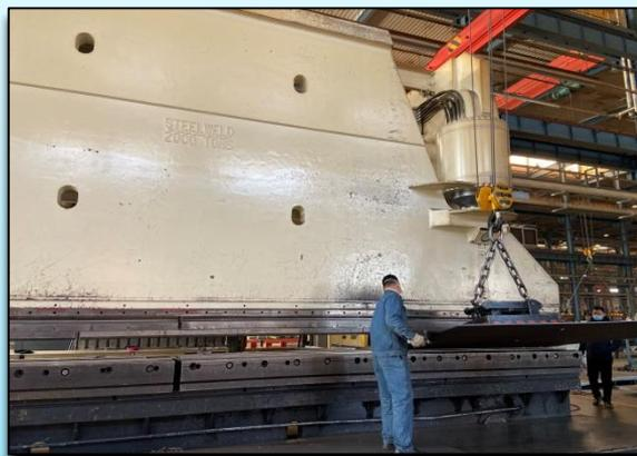
稀土耐磨鋼 NM450Ce 折弯成型
